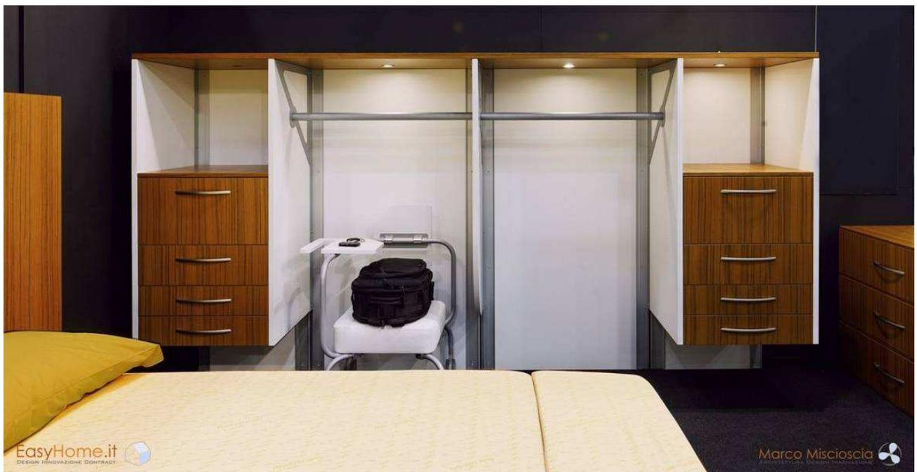
Armadio sospeso dotato di sportelli scorrevoli e di servetto manuale. Porte scorrevoli a scomparsa. E' stato lasciato libero lo spazio da terra fino a 70 centimetri per le manovre legate al movimento di una persona su carrozzina. Il mobiletto cassetiera su ruote può essere spostato a seconda delle necessità.
